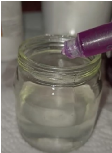
Imagen 3. Preparación de la solución de cal con indicador de col morada
